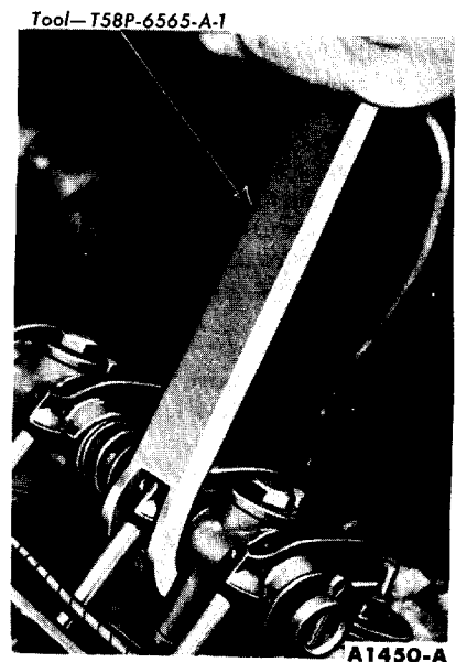
FIG. 42—Bleeding Down Hydraulic Valve Lifter
